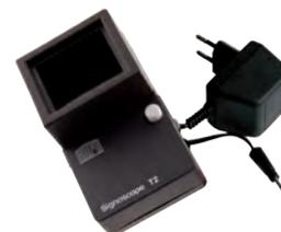
Le signoscope : un moyen simple, rapide et précis pour détecter les filigranes. Il vous permettra aussi de contrôler en toute sécurité l'état de vos timbres. Cet appareil moderne, pratique et performant est d'une utilisation simple.
