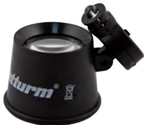
Loupe de bijoutier (à coincer dans l'orbite oculaire), pour examiner timbres et monnaies, pour réparer les montres etc. Grossissement X10. Lentille en verre (Ø 21 mm). Livrée avec LED orientable. Coque en plastique mat noir. Format extérieur: 49 x 38 mm
